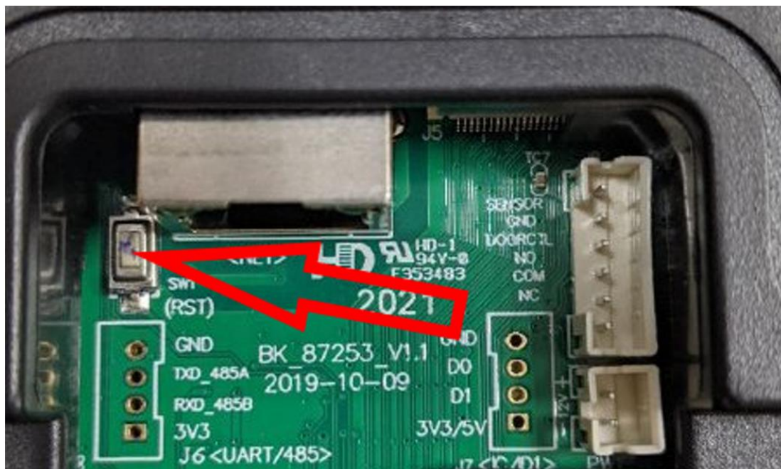
Obr. 2. Tovární reset – tlačítko na desce
