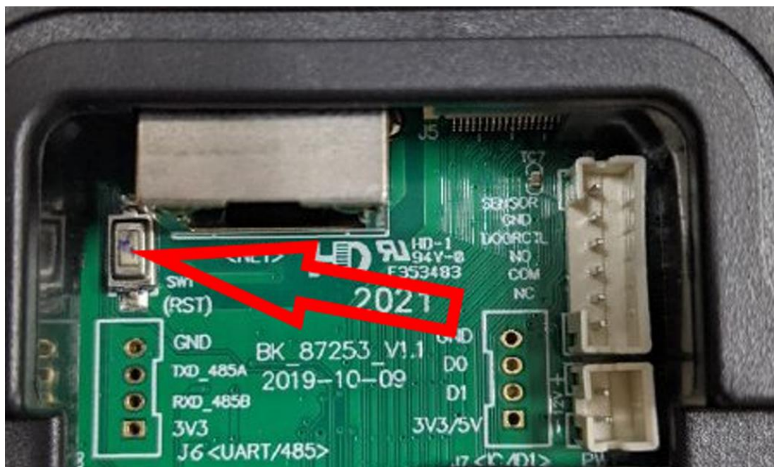
Fig. 2. Réinitialisation d'usine – bouton sur la plaque
