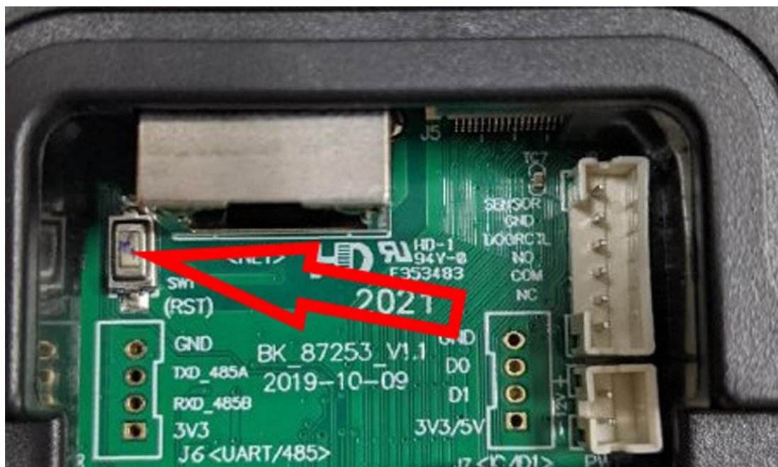
Rys. 2. Reset fabryczny – przycisk na płycie
