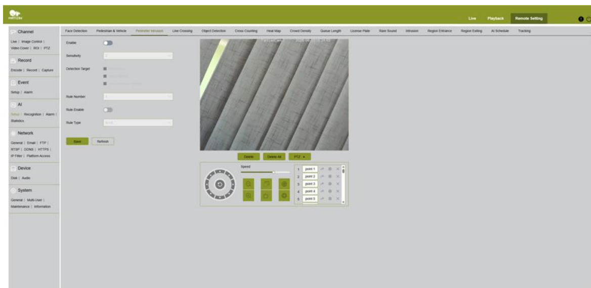
Fig. 40. IA → Configuration → Intrusion périmétrique — tracez une ligne périmétrique sur l'aperçu et définissez le sens de la règle (A→B)
