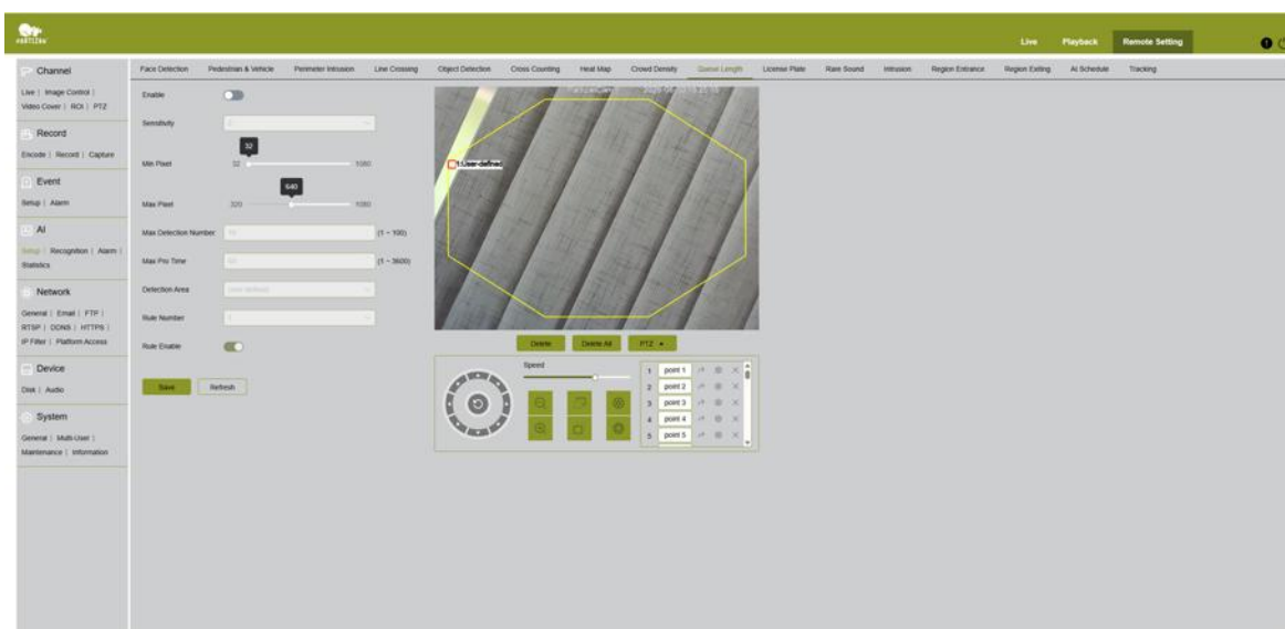
Fig. 46. IA → Configuration → Longueur de la file d'attente — nombre maximal de personnes détectées et durée maximale de traitement
