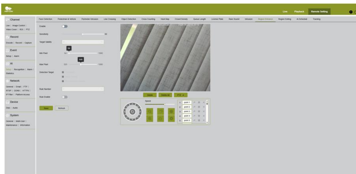
Fig. 50. IA → Configuration → Entrée dans la zone — détecte les cibles entrant dans une zone définie
