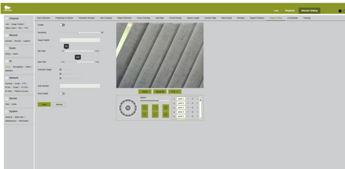
Fig. 51. IA → Configuration → Sortie de zone — sensibilité, validité de la cible, plage de pixels, cible de détection et zone de règle
