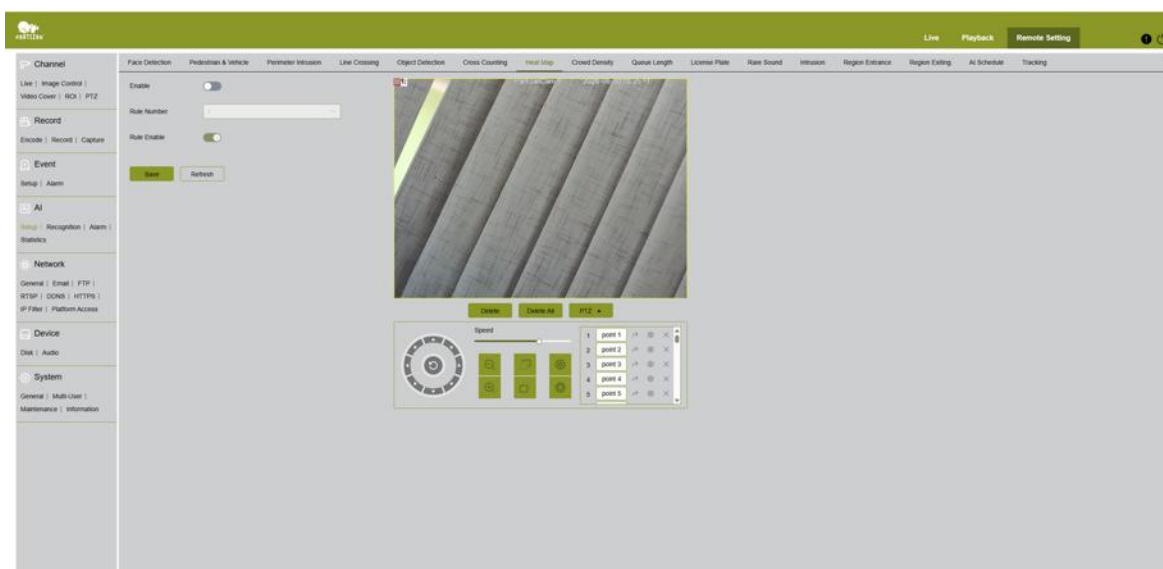
Fig. 44. IA → Configuration → Carte thermique — active le suivi de la densité d'activité spatiale pour la zone de règle sélectionnée
