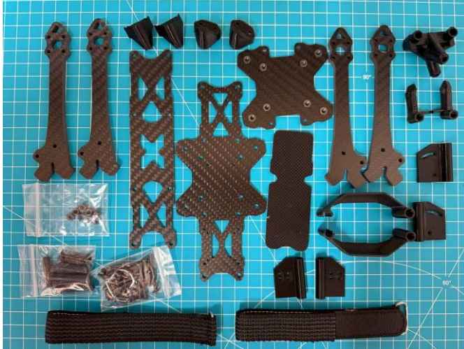
Composants du châssis.
